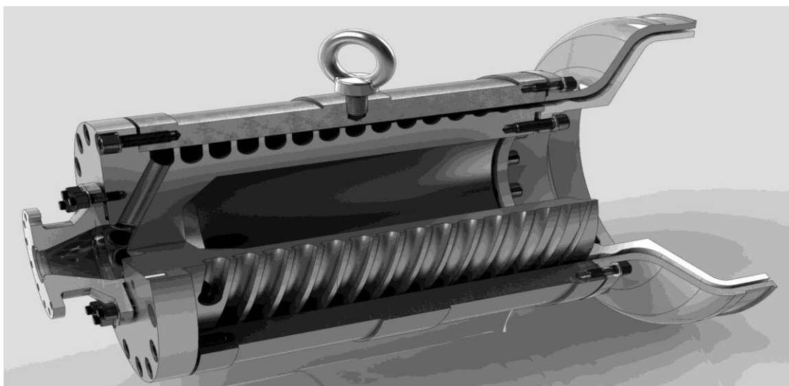
Рисунок 1 – Конструкція головки екструдера зі гвинтовою нарізкою
