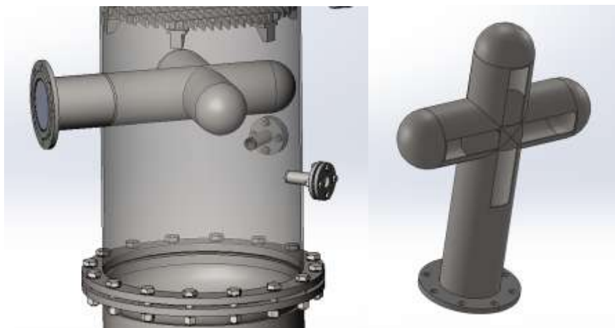
Рисунок 2 – Трубчастий колектор з отворами, спрямованими вниз.
