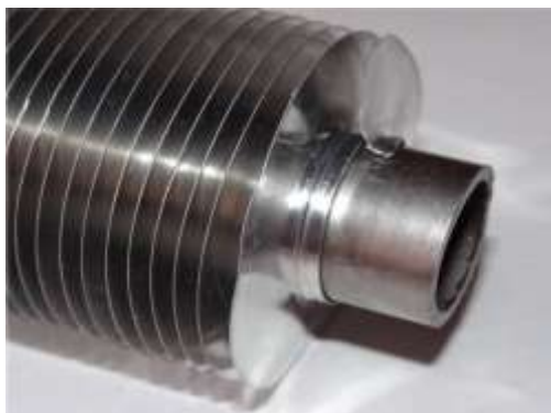
Рисунок 1 – Зображення ребер на зовнішньої поверхні труб
