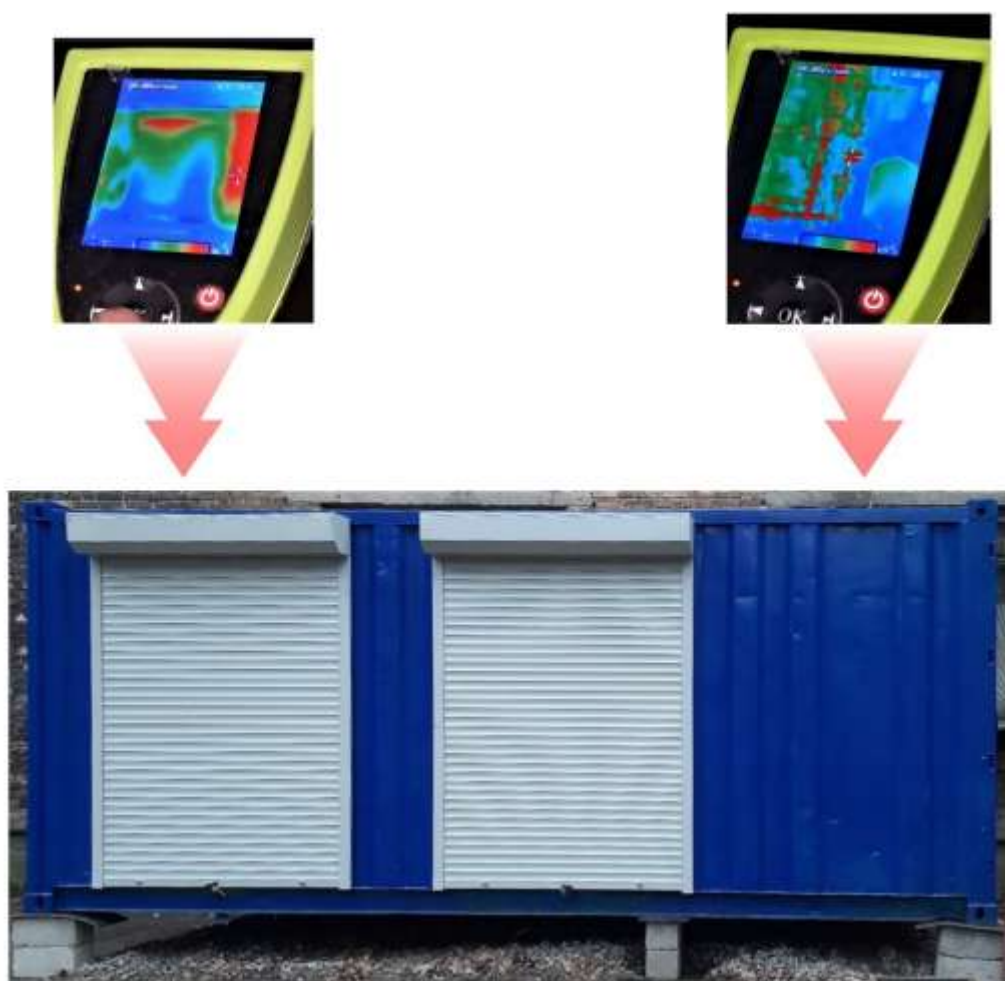
Рисунок 4. – Тепловізійна зйомка конструкції мобільного теплового акумулятора контейнерного типу МТА-0,5МВт
