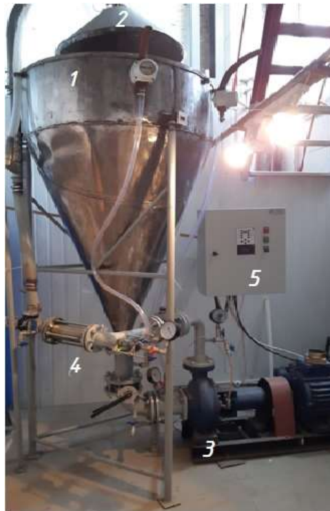
Рис. Аераційно-окислювальна установка роторного типу : 1- приймальна ємність; 2 – розпилююча голівка; 3 – роторно-пульсаційний апарат ; 4 - ежектор; 5 – блок керування.
