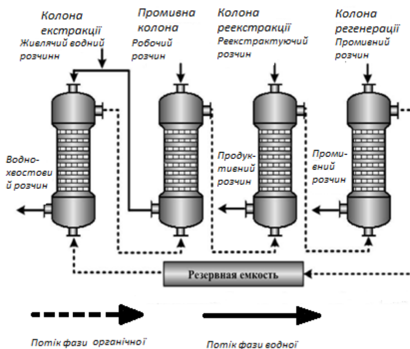
Рисунок 1.21 – Технологічна схема каскаду екстракційних колон
