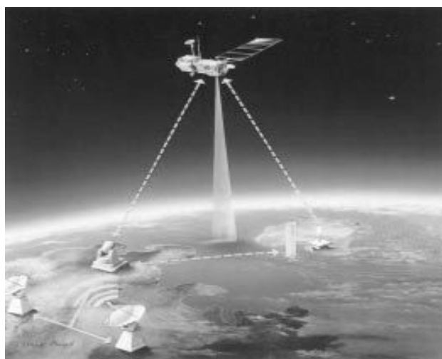
Рисунок 1 - Визначення положення супутників Землі за допомогою лазерної локації.
