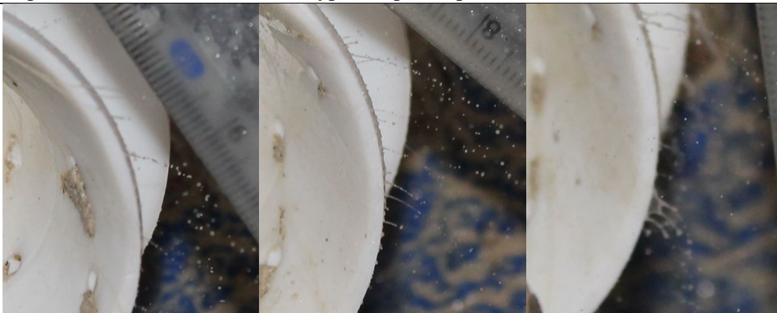
а) - G=6,0 кг/год б) - G=8,1 кг/год в) - G=11,7 кг/год Рисунок 5 – Фотознімки диспергування суспензії двоконусним диспергатором з фторопласту (кут змочуваності \theta = 87^{\circ}37' ) V_{л1} = V_{л2} = 9,43 м/с.
