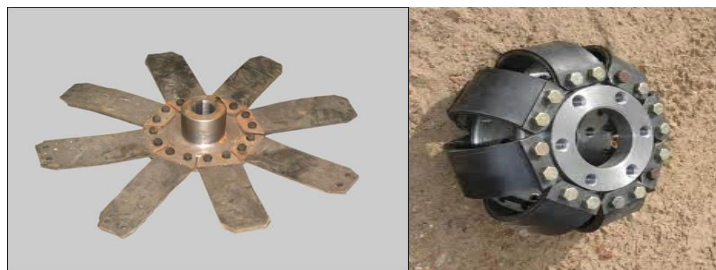
Рисунок 1. Пелюсткова муфта а – пелюстки; б – загальний вид муфти
