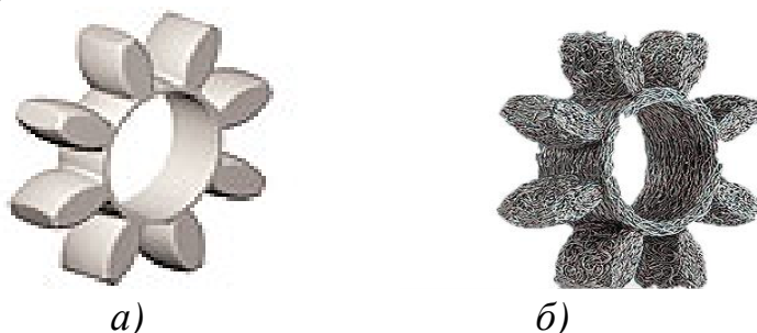
Рисунок2. Зубчастий вінець: а)–поліамідний; б)–дротяний
