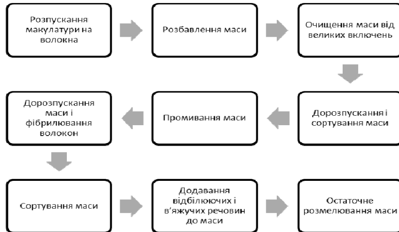
Рисунок 1 – Загальний вигляд технологічної схеми підготовки макулатурної маси при виробництві гофрокартону
