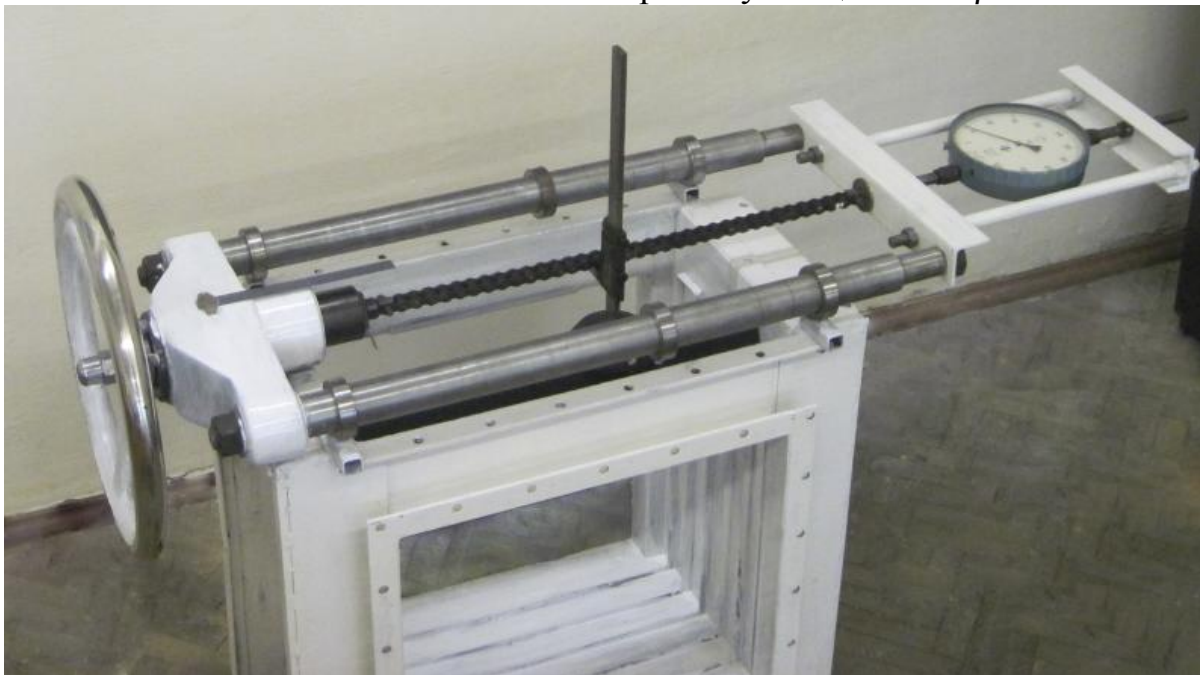
Рис. 2 – Експериментальний стенд з ланцюгом ДМ-11
