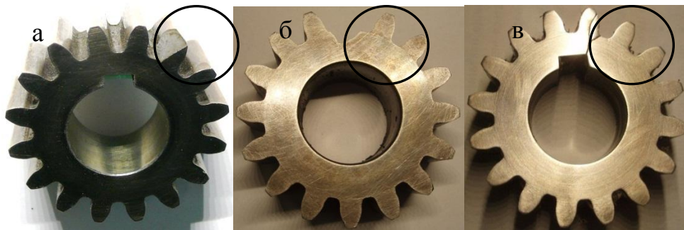
а – руйнування головок зубів, б – тріщини в основі зубів, в – тріщини у місці шпонкового паза
