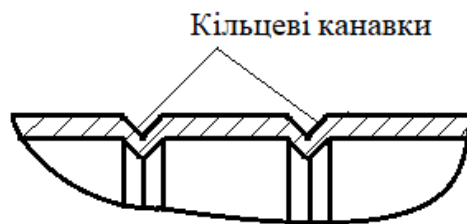
Рисунок 1.30 – Турбулізація потоку кільцевими канавками
