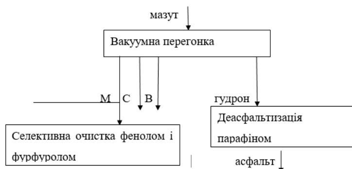
Рисунок 18.1 – Схема виробництва мастила
