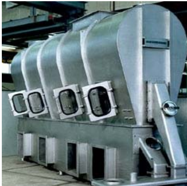
Рис. 2.11 – Багатосекційна установка псевдозрідженого шару [39]
