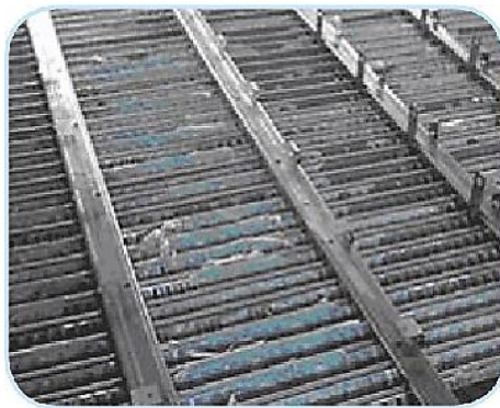
Рисунок 2.24 – Відбійник лопатевого типу
