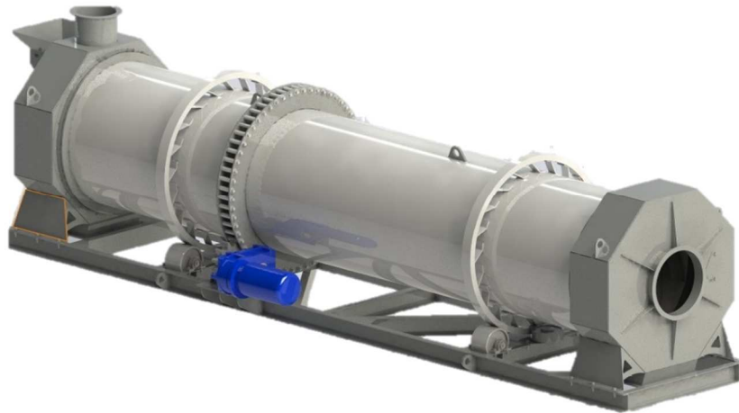
Рисунок 2.6 – Модель барабанного обертового апарату
