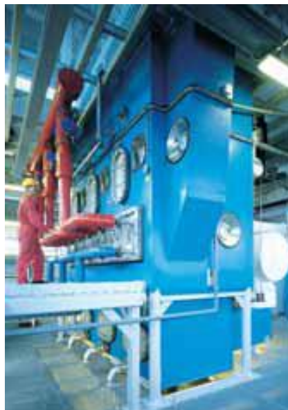
Рисунок 1.1 – Установка киплячого шару SPRAY FLUIDIZER
