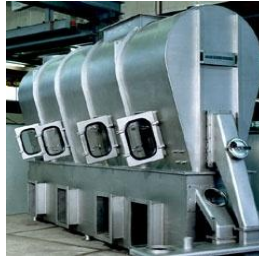
Рисунок 1.5 – Багатосекційна установка псевдозрідженого шару
