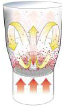
Рисунок 1.11 – Схема подачі розчину всередину шару знизу і подачі всього теплоносія під решітку апарата
