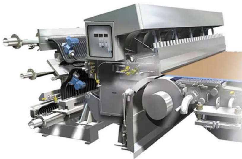
Рис. 1. Напірний ящик OptiFlo Layering Fourdrinier [1]
