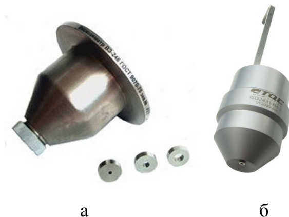
Рисунок 1 – Проточний чашковий віскозиметр з набором сопел (а) і занурюваний віскозиметр (б)
