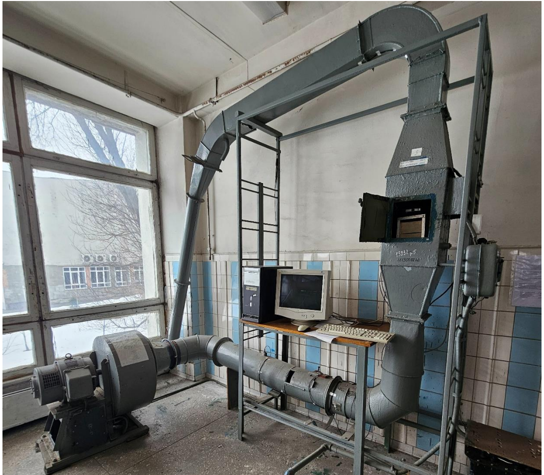
6. Установка: Дослідження процесу сушіння сипучих матеріалів у барабанній сушарці Відповідальний за методичне забезпечення: доц. Гайдай С.С. Відповідальний за роботу установки: Слабченко Б.О.
