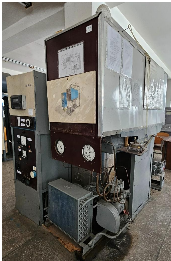
12. Установка для дослідження процесу помірнього охолодження повітря в паровій одноступінчастій холодильній машині Відповідальний за методичне забезпечення: доц. Гулієнко С.В. Відповідальний за роботу установки: Слабченко Б.О.
