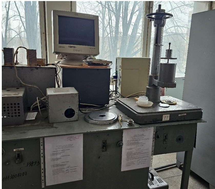
12. Установка для дослідження процесу помірнього охолодження повітря в паровій одноступінчастій холодильній машині Відповідальний за методичне забезпечення: доц. Гулієнко С.В. Відповідальний за роботу установки: Слабченко Б.О.
