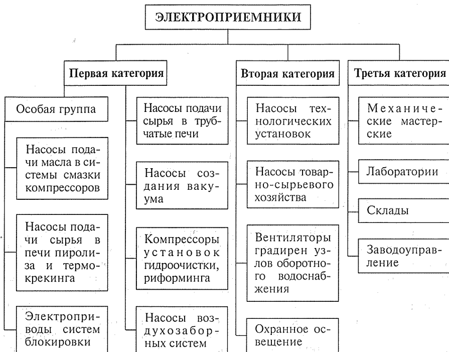
Схема 11.1. Категория электроприемников по надежности электроснабжения
