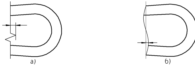
Рис. 54.6. Амплитуда: а) линии с изломом, б) волнистой линии (серым цветом показана средняя линия)
