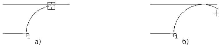
Рис. 19.17. Дуга по нормали, касательная к объекту: а) выбор объекта, б) указание конечной точки дуги
