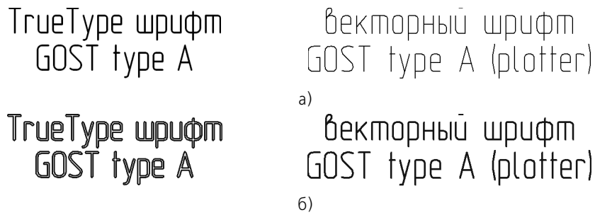
Рис. 37.5. Преобразование текстов в NURBS: а) исходные объекты – тексты, набранные TrueType-шрифтом и векторным шрифтом, б) результаты преобразования
