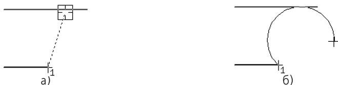
Рис. 19.15. Построение последующей дуги линии касательно к произвольному объекту: а) выбор объекта, б) указание конечной точки дуги
