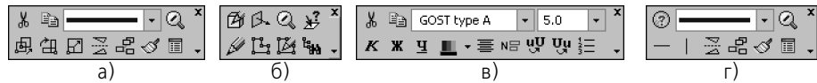
Рис. 7.2. Контекстная панель при выделении: а) геометрического объекта в чертеже или фрагменте, б) грани тела в сборке, в) фрагмента текста в текстовом документе, г) геометрического объекта в эскизе трехмерного элемента
