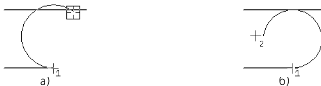
Рис. 19.14. Построение последующей дуги касательно к предыдущему сегменту и к произвольному объекту: а) выбор объекта, б) указание конечной точки
