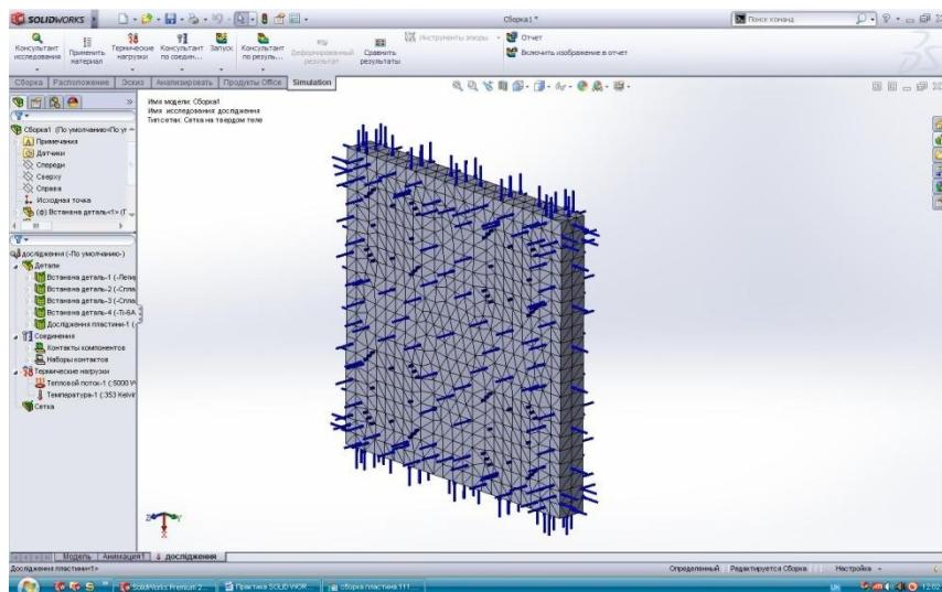
Результати дослідження програми SolidWorks для деталі типу «пластина»:
