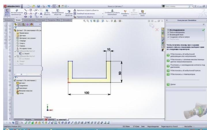
Побудова деталі «швелер-балка» за допомогою операції Видавлювання:
