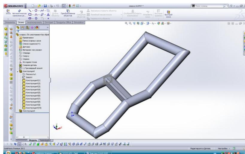
Вибираємо функцію «Сварная деталь» і розбиваємо отриману модель на прямі ділянки, які зварюємо, використовуючи функцію «Сварной шов».
