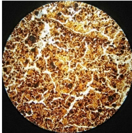
Рисунок 4.9 – Мікроструктура шару гумату калію післязневоднення при t = 70^{\circ}\text{C} (збільшення \times 36 )
