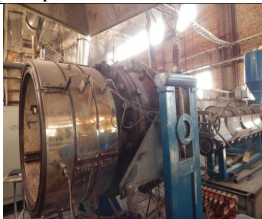
Рисунок 2 – Технологічні випробування нової марки поліетилену при виробництві труб великого діаметру з SDR > 30 .
