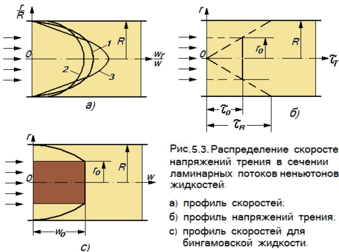
Рис.5.3. Распределение скоростей и напряжений трения в сечении ламинарных потоков неньютоновских жидкостей:
